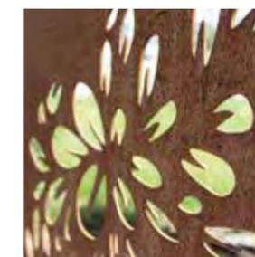
L'ACIER CORTEN est un acier auto-patiné à corrosion superficielle forcée. Son aspect rouillé changeant au fil du temps et sa
